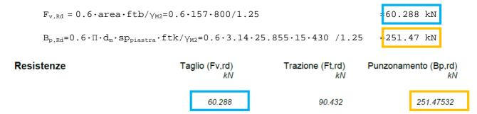
mentre invece la resistenza a trazione sarà la massima resistenza tra le diverse righe ottenuta con modello T-stub.
